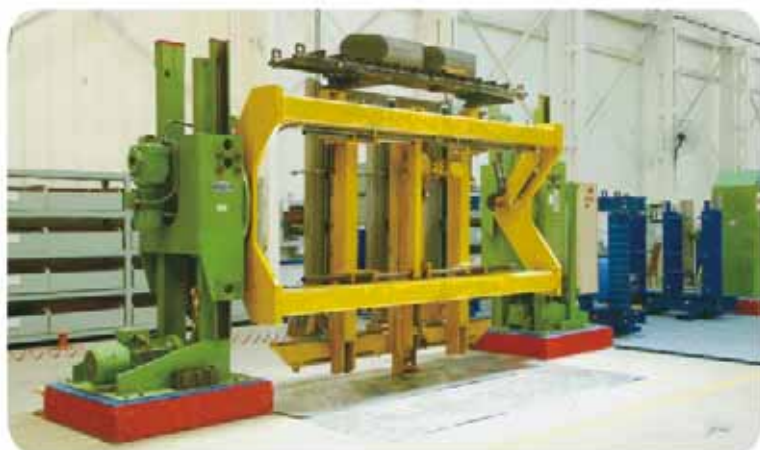
GEORG公司制造的铁芯自动翻转叠装台 GEORG stacking table
